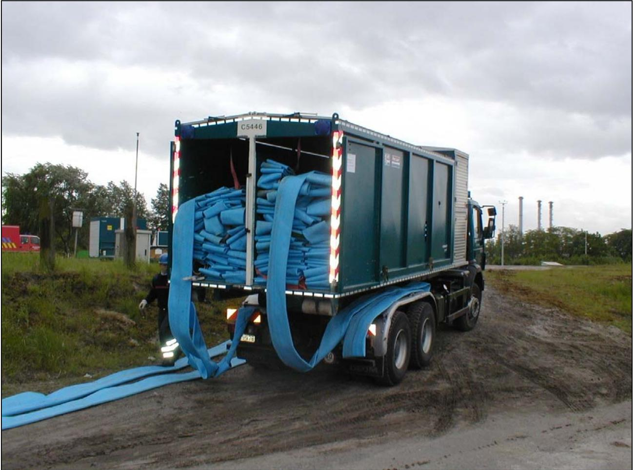
Utilisation : Ce système est utilisé pour transporter maximum 2200m de tuyaux de refoulement de 8" équipés de raccords Storz à trois griffes (1600 m sont livrés). Il permet de les dérouler et les enrouler à nouveau pendant que le véhicule roule au pas.
